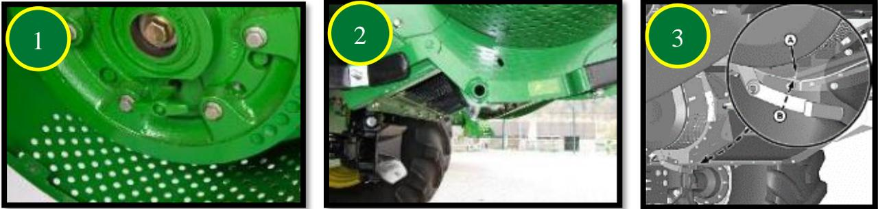
Le déflecteur de rafles n° 1 doit être en position relevée/petites céréales. Les ailettes du déflecteur arrière ou du volet de broyage/andainage n° 2 sont réglables afin d'améliorer la répartition des résidus.
